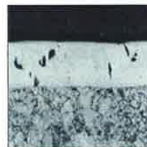
硬質クロム(クラック欠陥あり)
