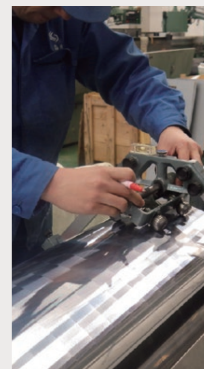
【 キャリパーによる円筒度計測 】
