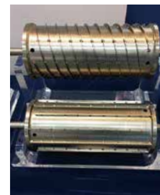
【熱媒循環式ロールの内部構造】 ※上がスパイラル、下がペリフェリ
